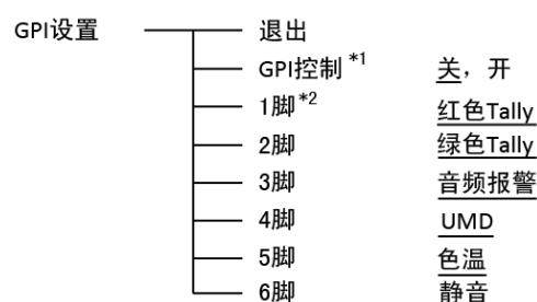
\*1 设置为“开”时，用户可通过外部 GPI 控制端，对监视器进行快速操作。
